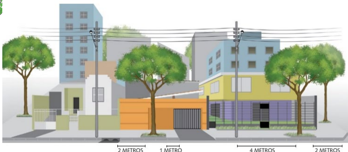
FIGURA 11 – Distâncias mínimas dos diferentes equipamentos urbanos.
